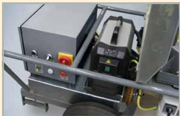
Le moteur et le compresseur sont faciles d'accès. Au besoin, le compresseur se retire simplement.
